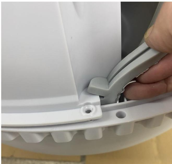
⑨ 計6カ所のネジを外せばフェンスとカバーが外れますので、ラバーを交換し、再度フェンスとカバーを取り付けてください。
