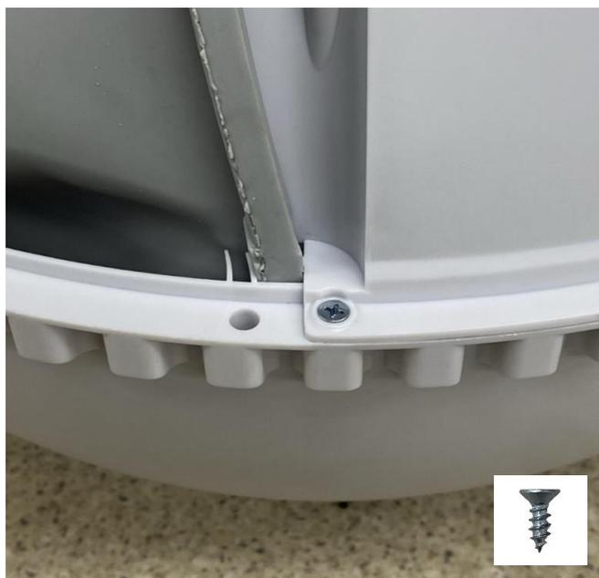
⑯ 後面下部パーツを取り付けます。ラバー端の盛り上がった部分（矢印部分）に、後面下側パーツ内側にある溝を合わせながら取り付けます。
