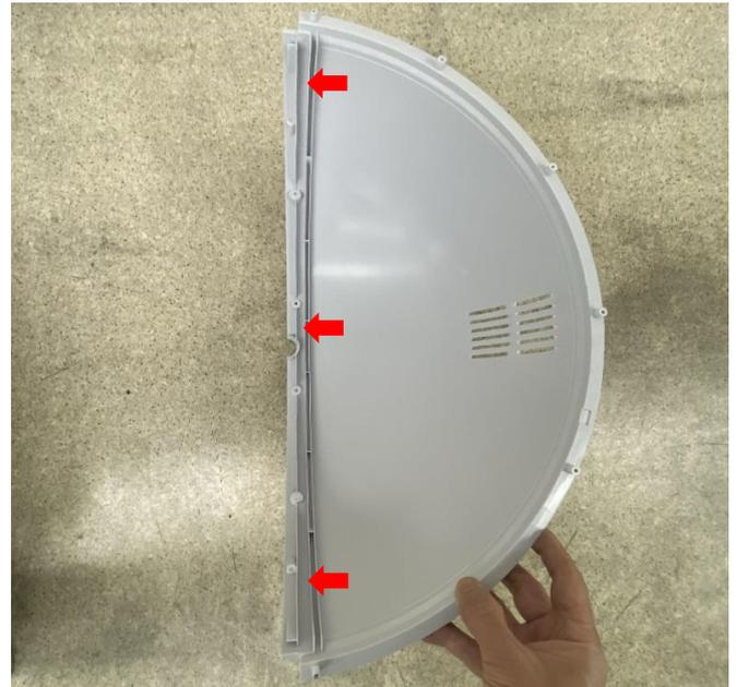
⑱ 溝に合わせてドームパーツがかぶされば、ネジを止めていきます。最初は○印の部分から止め、最後に、後面中央のキャップも止めてください。
