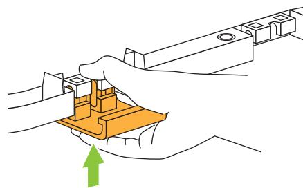
バックルのアームを垂直に立てて、手で挟みこむ様に力を入れて取り付けます。
