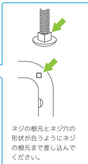
ネジの根元とネジ穴の形状が合うようにネジの根元まで差し込んでください。
