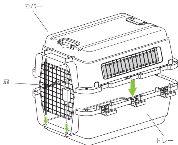
**2** トレーとカバーで挟むように扉を取り付けます。
