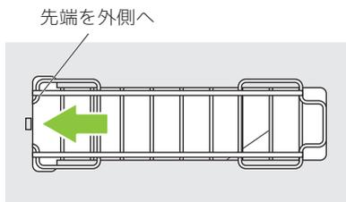
**2** 逆方向にスライドさせて、先端を外側へ押し出します。
