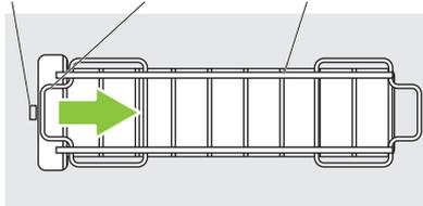
**1** 窓フレームをスライドさせて、先端を出っ張りから外します。
