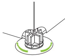
ベースジョイントの粘着シートはフローリングなど表面が平らな床でのみ使用できます。カーペットや凹凸のある床にはくっつかないのでご注意ください。また、ホコリ等の汚れがあると粘着力が著しく低下するので予めホコリ等を取り除いてから設置してください
