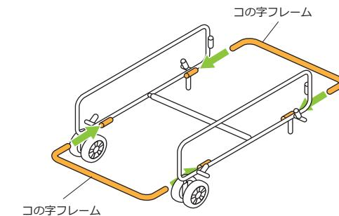
**3** サイドフレームにコの字フレームを取り付けます。
