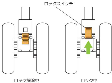
前輪のロックスイッチを上に上げるとロックが掛かります。ロックスイッチを下げるときロックが解除されます。
