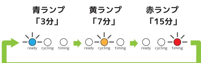
レディランプ（青ランプ）が点灯中にエンプティボタンを3秒以上長押しすると現在設定中の時間に対応したランプが点滅しカウントタイマー変更モードになります。
