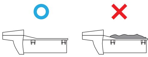
袋をコンテナに取り付けるときはコンテナのフチから袋がはみ出さないように注意してください。はみ出すと青ランプが点滅し、正常に作動しない場合がございます。
