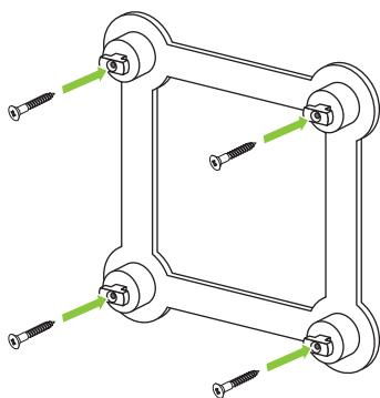
壁付け用ホルダーをネジで固定します。
