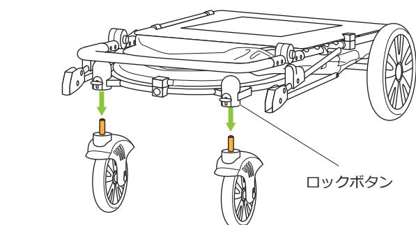
**5** ロックボタンを押しながら、前輪と後輪を引き抜きます。
