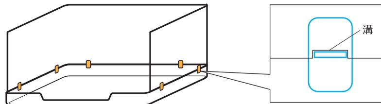
ジョイントを左右にずらし、飛散ガードの溝に合うようにしたら完成です。
