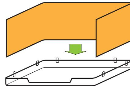
飛散ガードを取り付けます。
