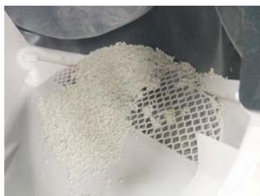
かなりの量が網目に詰まって砂が残る
