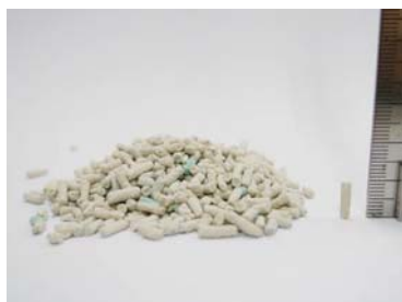
砂の大きさは10mm程度の円柱型
